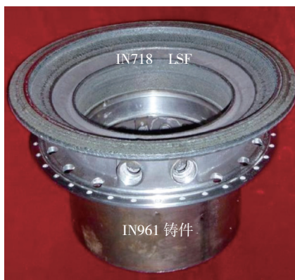
图5 轴承后机匣激光修复
