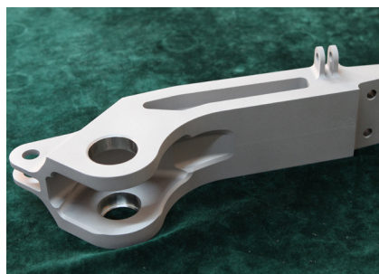
图4 电子束熔丝沉积成形典型零件
