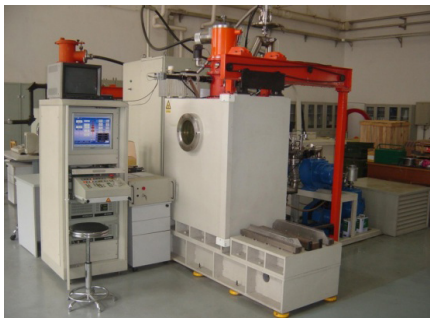
(a) 60kV/8kW 定枪式设备
