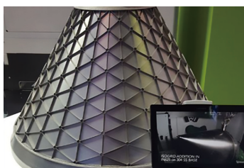
(b) BeAM 公司零件表面网状结构添加
