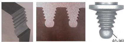
图12 超硬磨料成形砂轮样件加工
