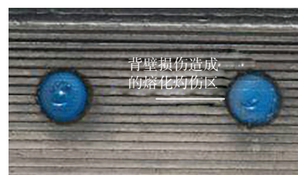
(b) 背壁损伤造成的熔化灼伤区
