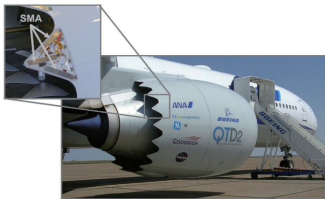
图4 波音777-300ER飞机发动机利用形状记忆合金降噪
