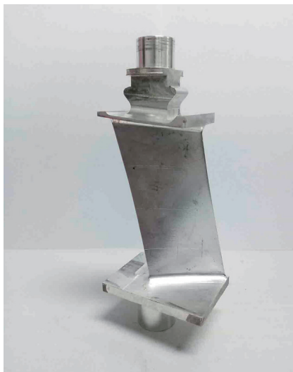
图8 金属基复合材料叶片
