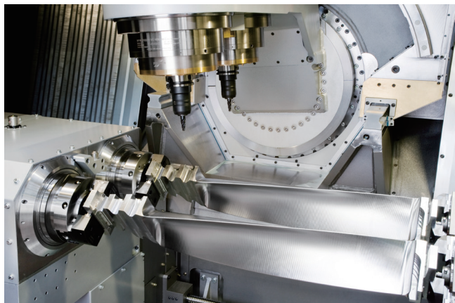
图1 叶片五轴数控铣削加工
