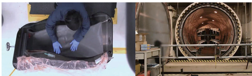
(a) 模具中的复合材料叶片
