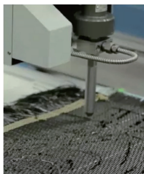
(a) 碳纤维预制体的超声切割加工
