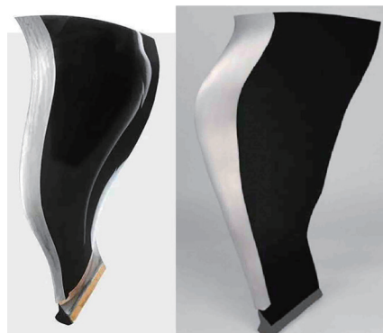
(a)GE90 风扇叶片 (b)LEAP-X 风扇叶片
