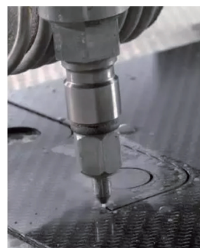
(b) 碳纤维复合材料的水切割加工
