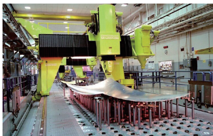
图5 壁板零件多点阵真空吸盘式柔性工装
