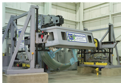
(b) 波音 787 发动机进气罩自动铆接
