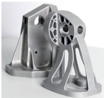
图6 激光3D打印(前)及铸造的(后)空客机翼支架
