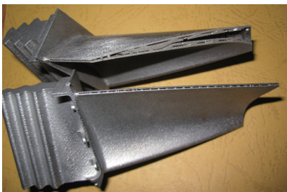
图7 内置流道的航空发动机叶片
