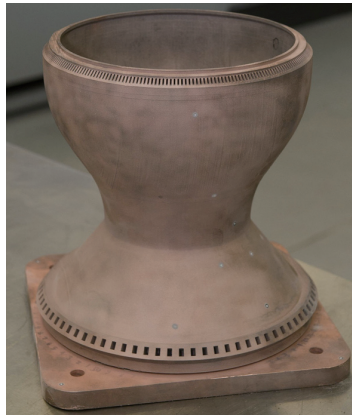
图4 NASA打印的铜合金火箭发动机零件
