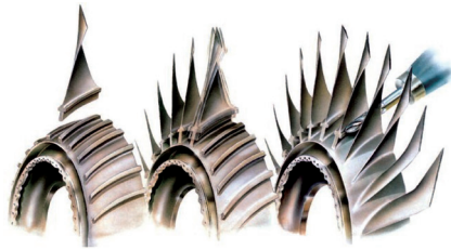
图5 特种焊接技术:整体叶盘线性摩擦焊主要工艺过程
